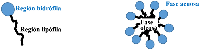
Figura 1. Izquierda: Representación de una molécula de tensioactivo. Derecha: Representación de una gotícula de emulsión O/A.
